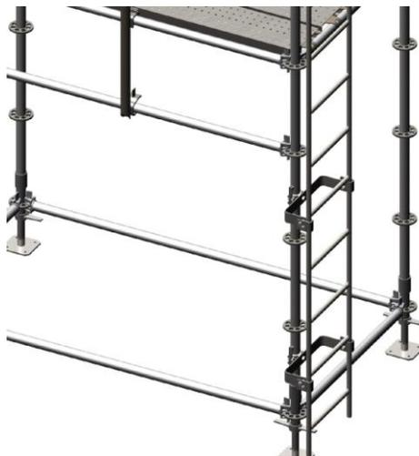
Échelle à 90° attachée à un montant de l'échafaudage
