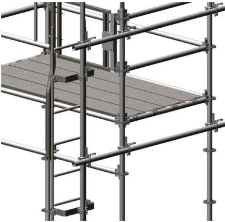
Échelle à 90° attachée à un tuyau vertical fixé à des tuyaux horizontaux
